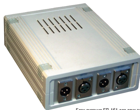
Блок питания БП-161 для двух электретных микрофонов. Возможно встраивание микрофонного усилителя. Габариты - 158x65x205 мм. Масса - 1115 г. Соединитель - трехконтактный XLR
